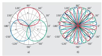
**Рис.3.** Секторизация сайтов с помощью масштабируемых антенн: а) типовой трехсекторный сайт (используются частотные каналы  $F_1$ ,  $F_2$ ,  $F_3$ ); б) диаграммы 6-лучевой антенны (используются частотные каналы  $F_1$ ,  $F_2$ ,  $F_3$ . Коэффициент повторного использования частоты – 3:1)
