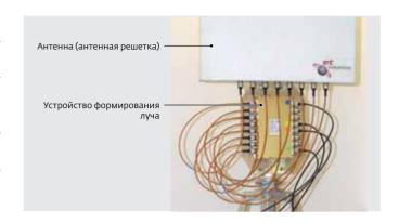
Рис.1. Многолучевая (восьмилучевая) антенная система
