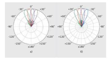
**Рис.2.** Полученная экспериментально (а) и сгенерированная посредством программного моделирования (б) диаграммы направленности четырехлучевой антенной системы
